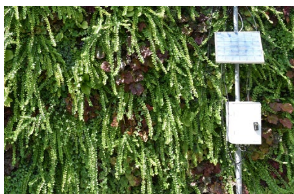
Čidla a měřiče teploty fasády
