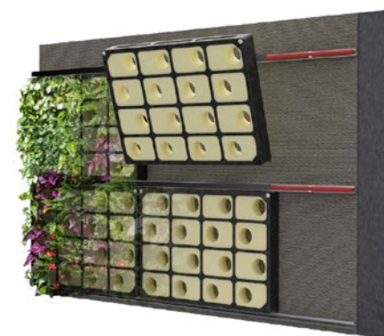
Hydroponická fasáda BioTile. Použití: exteriér; konstrukce: modulární, nenosná; hmotnost: nasycená kazeta 65 kg/m 2 , tloušťka systému: 82 mm; výplň: hydrofilní minerální vlna; zálaha: automatická kapénková; maximální výška: bez omezení; maximální šířka: bez omezení; rozměr kazety: 600/450/62 mm. (Foto: archiv LIKO-S)
