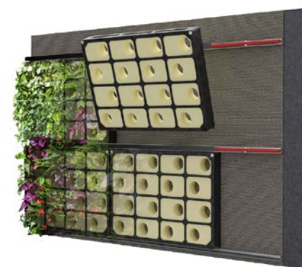
Hydroponická fasáda BioTile. Použití: exteriér; konstrukce: modulární, nenosná; hmotnost: nasycená kazeta 65 kg/m 2 , tloušťka systému: 82 mm; výplň: hydrofilní minerální vlna; zálaha: automatická kapénková; maximální výška: bez omezení; maximální šířka: bez omezení; rozměr kazety: 600/450/62 mm. (Foto: archiv LIKO-S)
