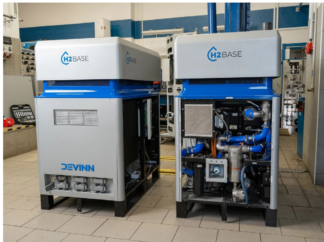
Generátor H2BASE může vodík následně přeměnit zpět na elektrinu a teplo zcela bez emisí CO 2 a dalších skleníkových plynů
