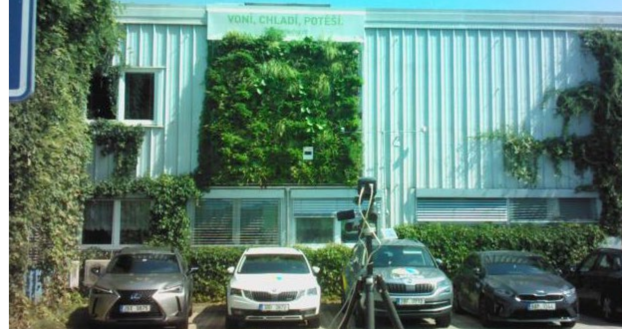
Pohled na fasádu haly; hliníkový povrch, např. tmavý hliníkový plech, může mít v letních měsících až 70 °C, zatímco zelený povrch si drží 30 °C
