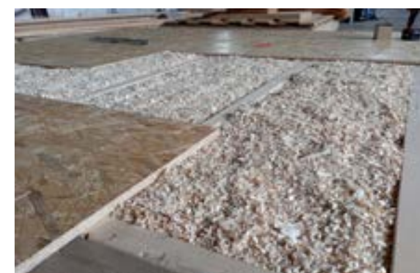
Příprava vzorku stěny s tepelnou izolací z hoblin, opláštění nosného rámu deskami z OSB.
