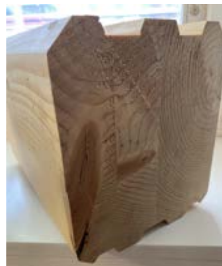
Různé profily zámkového spoje srubu.
