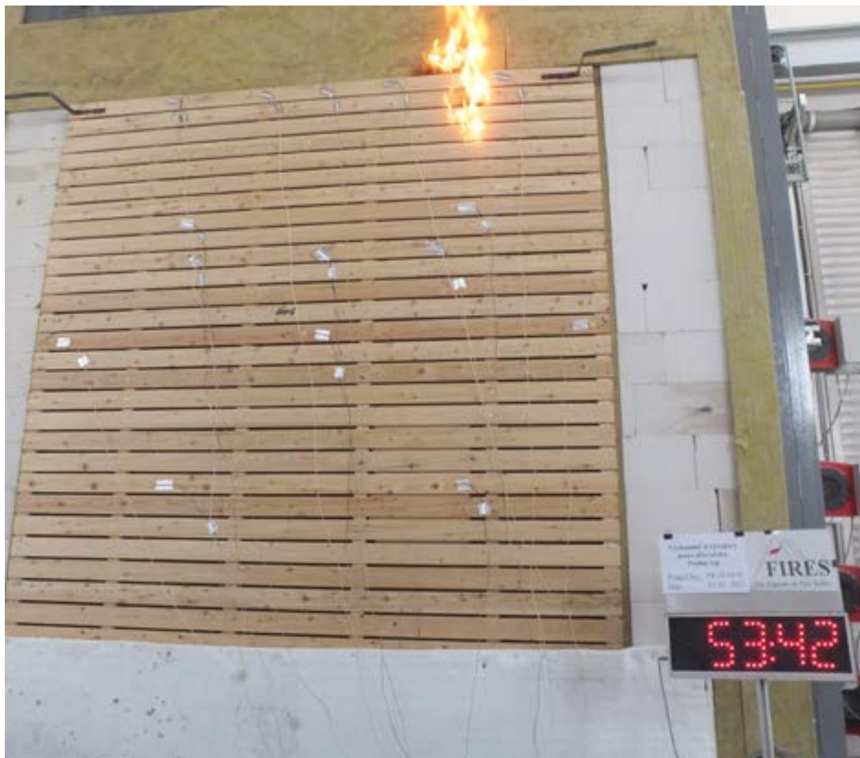
Pohled na srubovou stěnu během zkoušky požární odolnosti.
